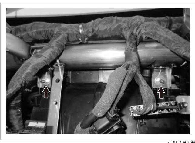
9. 拆下仪表板加强梁中部下侧 2 个螺栓
